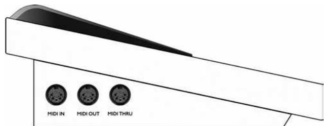
Um Merish 4 von einem externen Instrument zu spielen, muss der Ausgang Midi Out des Master Keyboard (oder einem anderen Midi-Peripheriegerät) an den Eingang Midi IN von Merish 4 angeschlossen werden. Jetzt können die Klänge von Merish 4 eingestellt werden: auf "MASTER" klicken und die entsprechende Bildschirmseite öffnen. Auf der rechten Seite befinden sich die Schnittstellenverbindungen mit den Instrumenten:
